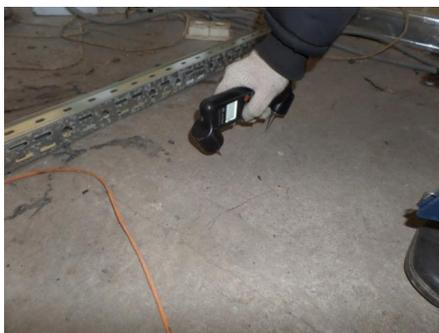
Фото 2. Испытание монолитной плиты перекрытия ультразвуковым методом прибором Пульсар-2М
