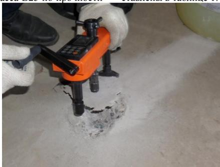
Фото 1. Испытание монолитной плиты перекрытия метом «отрыв со скалыванием» прибором ОНИКС-ОС
