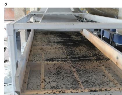
сей осуществляется при помощи пневматического пылеуловителя, входной патрубком которого расположен над ситами просеивателя. Сита в количестве шести штук обеспечивают получение резиновой крошки следующих фракций: 0...0,5 мм; 0,5...1,2 мм; 1,2...2,2 мм; 2,2...3,2 мм; 3,2...4,2 мм (Рисунок 2). Последняя фракция свыше 4 мм подвергается доработке с помощью дробилки.
