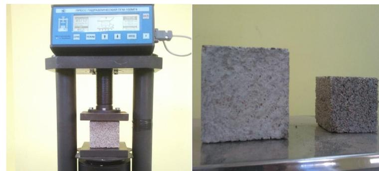
Рис.2. Испытание бетонных образцов на прочность
