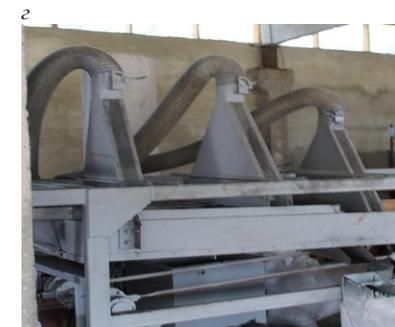
Рис. 2. Оборудование технологической линии по переработке изношенных автомобильных шин: а – решетка вибратора для отделения текстиля и крупных включений из общей массы продуктов переработки; б – механизм подачи резиновой крошки для последующего разделения по фракциям; в – сито просеивателя; г – пылеуловитель с системой сит
